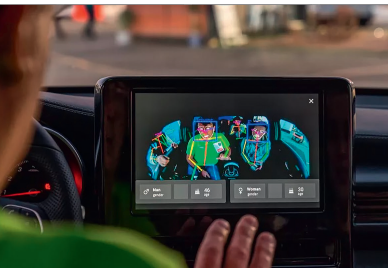
Bild 3: Smart Cocoon erwärmt die Fahrerkabine mithilfe von KI für jeden Insassen individuell. © Valeo
